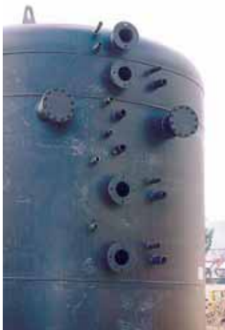
◀ Sowohl Speicheranschlüsse als auch Fühlerpositionen bereits auf der Produktionsskizze des Speichers fix vorgeben.
