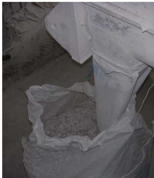
Abbildung 12: Abgetrennter Karton von Gipskartonplatten
