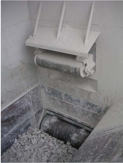
Abbildung 10: Aufgabestelle von Gipskartonplatten in eine Wiederaufbereitungsanlage
