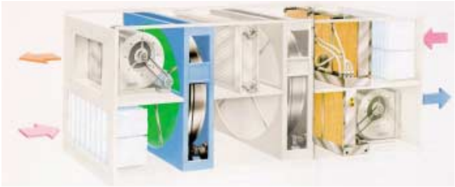
Komponentenanordnung des Desiccant-Klimagerätes im Ökopark Hartberg (Grafik: Firma Munters)
