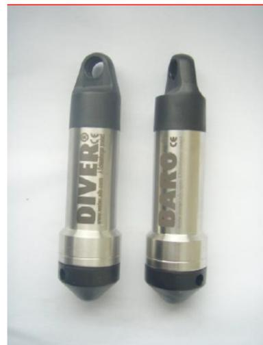
Abb. 9: Kunststoffpegelrohr mit Schlitz-Perforation zum Einsetzen (Aufhängen) der Autopegel (hier noch ohne Sicherheitsverschluss) bzw. Autopegel („Diver“) und Baropegel der Fa. Eijkelkamp, NL.
