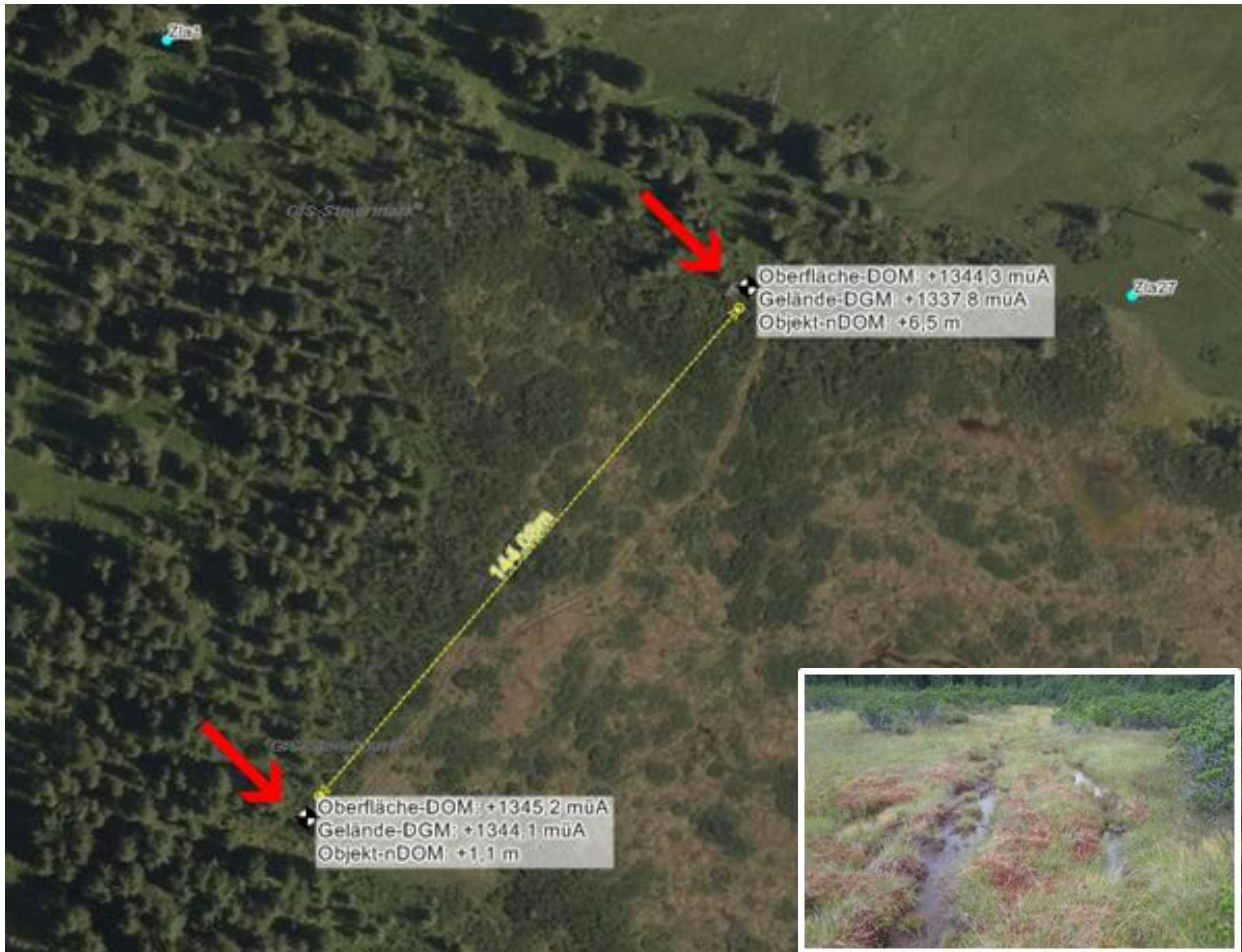
Abbildung 6: Die knapp 150m lange Fahrspur im großen Hochmoor (LRT 7110). Die Höhendifferenz zum Tiefpunkt am oberen Bildrand beträgt über 6m. Unten rechts ein Bild der Fahrspur; man erkennt, dass sich das Wasser hier sammelt.
