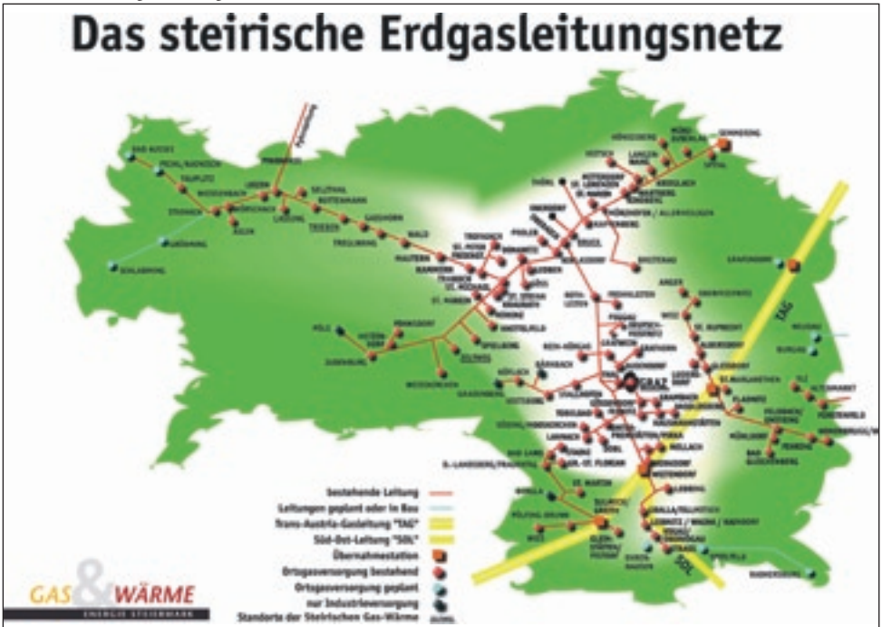
Steirisches Erdgasleitungsnetz, Jänner 2004
