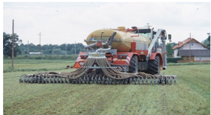
Günstige bodennahe Gülleausbringung mittels Gülletrac mit Schleppschlauchsystem bei Schärding (OÖ) (Quelle: BAL Gumpenstein, Buchgraber)
