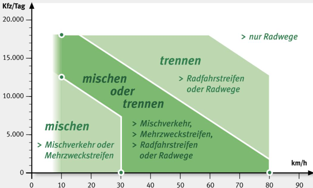
Hinweise für die Mischung bzw. Trennung von Rad- und Kfz-Verkehr in Abhängigkeit von Verkehrsstärke und Geschwindigkeit für zweistreifige Fahrbahnen
