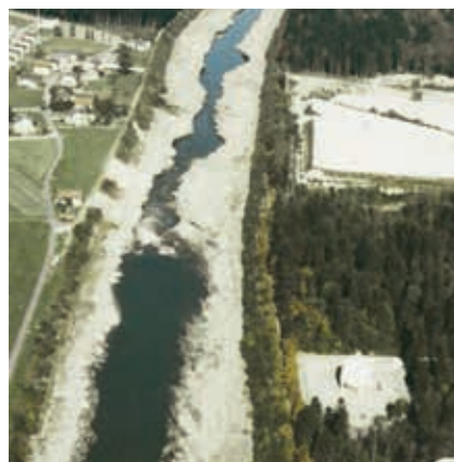
Abb. 1b: Beispiele für Sedimentdefizit: Sohldurchschlag (rechts) und Einsturz der Autobahnbrücke Liefering (links) an der Salzach vom 13.08.1969 (WRS, 2000)
