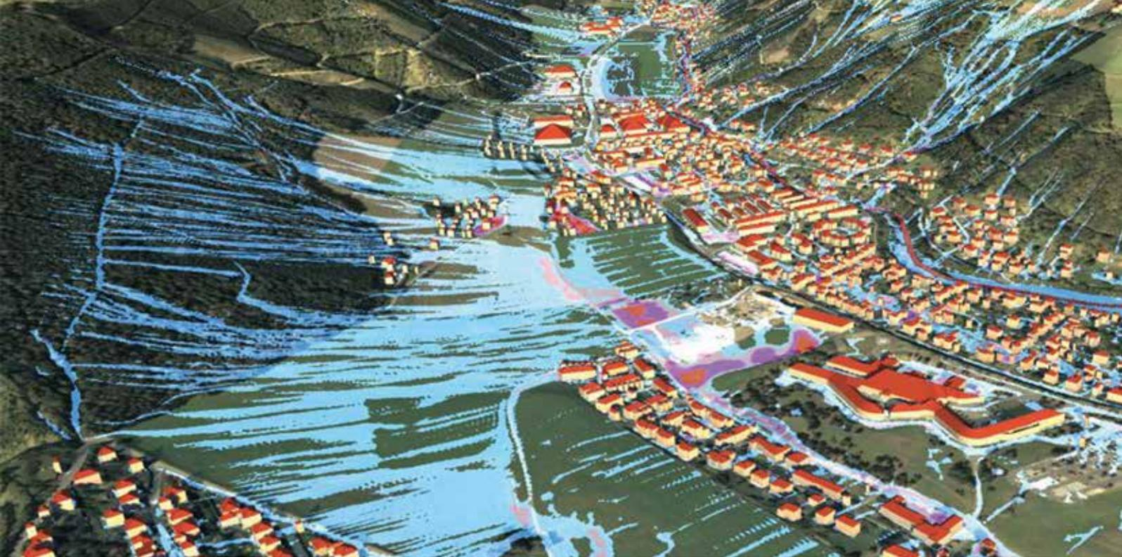
Abb. 1: Hangwasserkarte Kapfenberg, 3D-Stadtmodell mit Wassertiefenklassen für ein 10-jährliches Regenereignis mit einem Blockregen von 15 Minuten © Büro Pieler ZT GmbH und Hydrosim Consulting
