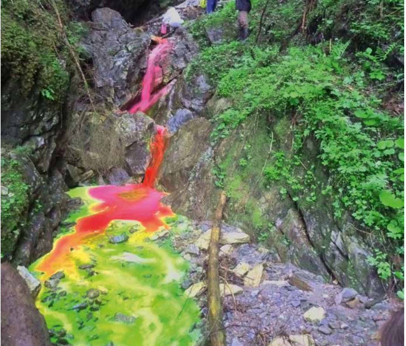
Abb. 6: Einspeisen von zwei Markierungsstoffen (Grün = Uranin und Rot = Sulforhodamin) in eine Bachschwinde unterhalb des Bärenkars © Gerfried Winkler
