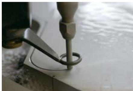
Abb. 2: Schneiden von Metallblech mit einem Wasserstrahl © Wikipedia/Bystronic/CC BY-SA 2.5
