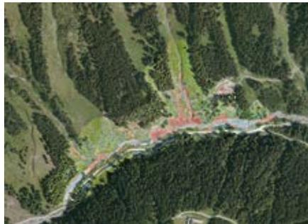
Abb. 16: Differenzenmodell von der Drohnenbefliegung vom August 2023 und Laserscan aus dem Jahr 2012 in der Schluchtstrecke hm 15 – 19; rot: Erosionen, blau: Auflandungen © WLV Sektion Steiermark
