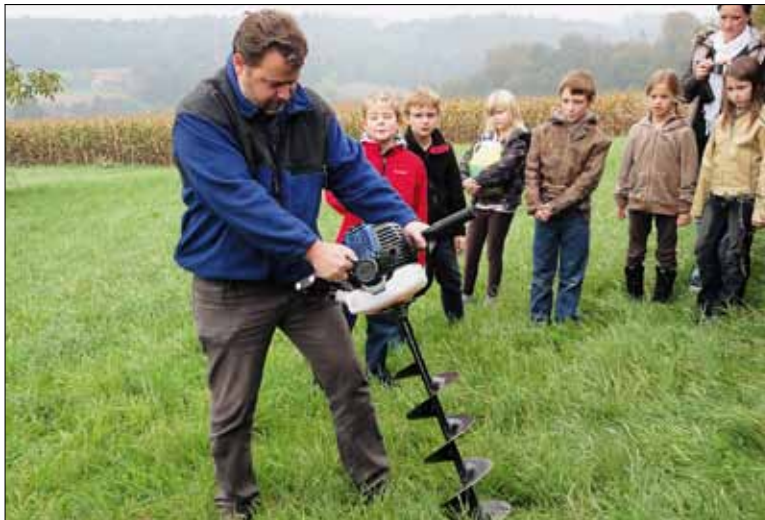
Abb. 1: Vorbereiten des Sickersversuchs
