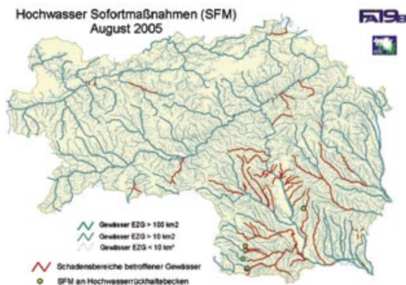
Abb. 1: Hochwasserschäden an Gewässern der Bundeswasserbauverwaltung
