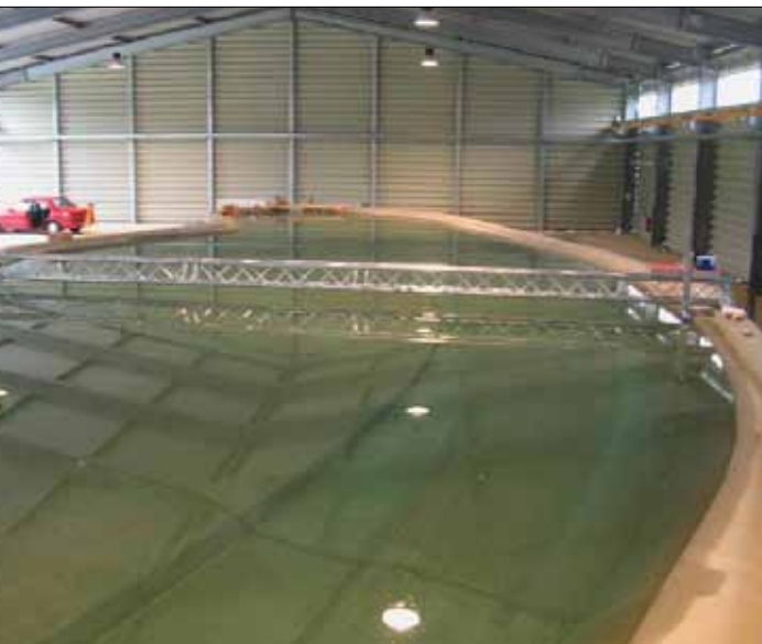
Abb. 8: Stauraum Feistritz mit Messtraversierung
