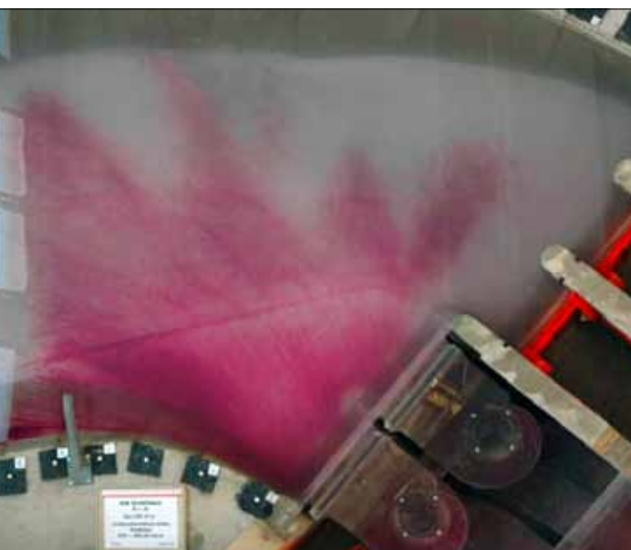
Abb. 9: Kraftwerk Schönau an der Enns, Zuströmung zu den Turbineneinläufen
