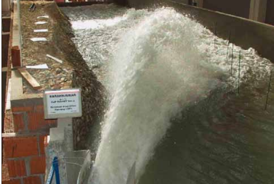
Abb. 4: Abwurfstrahl an der Sprungschanze Kárahnjúkar
