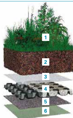
Abb. 2: Aufbau – Intensivbegrünung © BAUDER Ges.m.b.H.
