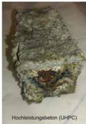
Entwicklung innovativer und dauerhafter Baumaterialien (12-monatige Auslagerung) © TU Graz
