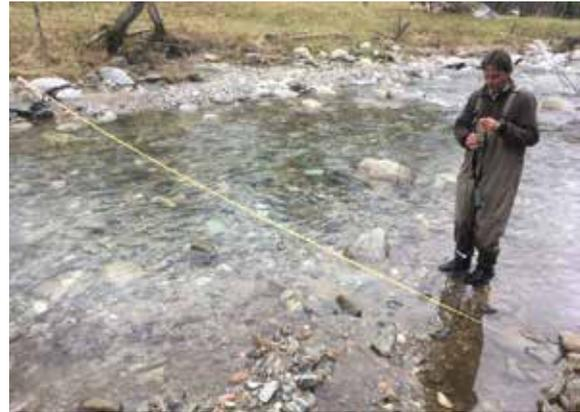
Abb.1: Messung des Abflusses unterhalb der KW-Anlage\*
