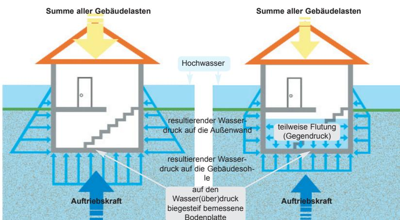
**Grafik 4: Sicherung gegen Auftrieb durch ausreichende Gebäudelast.** Die Summe aller Gebäude-lasten muss mindestens 10% größer sein als die Auftriebskraft. Die Bodenplatte sollte unbedingt biegesteif gegen Wasserdruck ausgeführt sein.
