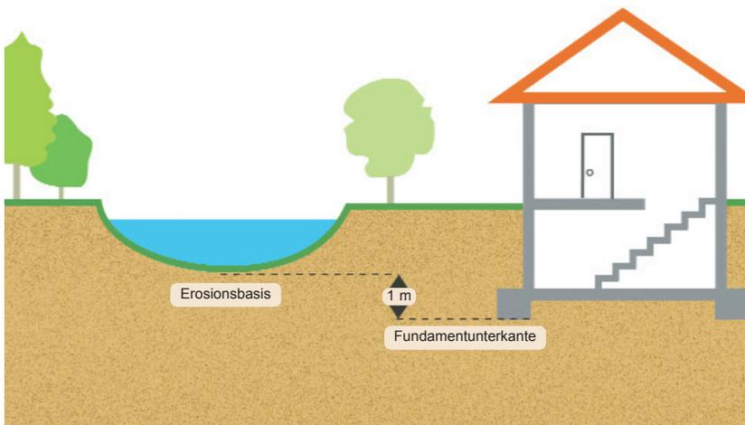
**Grafik 7: Sicherung gegen Erosion und Unterspülung.** Durch ausreichende Fundamenttiefen kann die Unterspülung von Anlagen und Gebäuden vermieden werden. Die Fundamentunterkante muss mindestens 1 m unter der zu erwartenden Erosionsbasis liegen.
