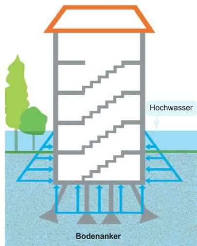
**Grafik 6: Sicherung gegen Auftrieb durch Verankerung** des Gebäudes oder der Sohle im Baugrund durch ausreichend bemessene Anker oder Pfähle.
