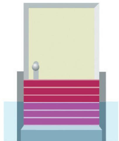
**Grafik 17: Dammbalken** in Form von passgenau zugeschnittenen Einsatzstücken für Tür- und Fensteröffnungen mit Profildichtungen bieten einen guten Schutz auch bei höheren Überflutungen.
