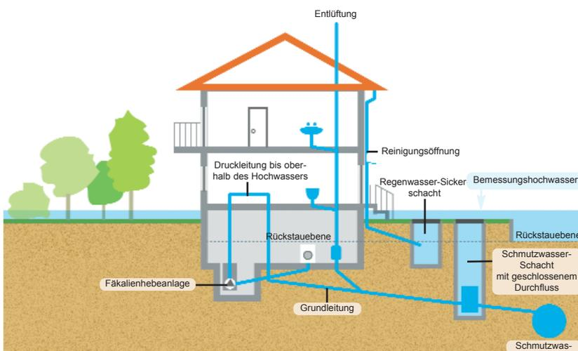
**Grafik 14: Hausentwässerung mit Schutz vor Rückstau aus dem Kanalnetz.** Ohne Sicherheitseinrichtungen kann der Wasserspiegel im Leitungsnetz des Gebäudes bis auf das Wasserspiegelniveau im Kanalnetz ansteigen. Dies kann u.a. Wasseraustritte aus den Abflüssen der Sanitäranlagen zur Folge haben.
