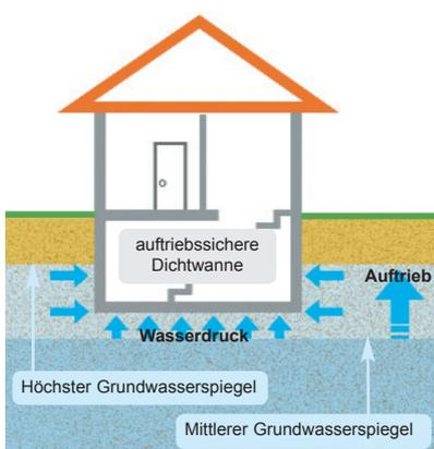
**Grafik 1: Auswirkungen von Grundwasseranstieg.** Steigt das Grundwasser über das Niveau der Gebäudesohle, entstehen Auftriebskräfte und Wasserdruck. Die Größe des Auftriebs hängt von dem durch das Gebäude verdrängten Wasservolumen und somit von der Höhe des Grundwasserstandes ab.
