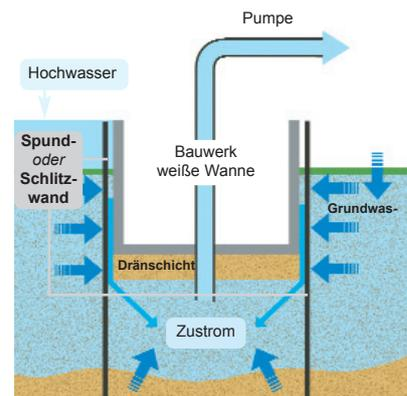
**Grafik 8: Wasserhaltung durch Regulierung des Grundwassers mit Spundwänden und Pumpen.** Eine Wasserhaltung bei Hochwasser ist nur wirksam, wenn die durch Grundwasserzuströmung und Oberflächenwasser anfallende Wassermenge kleiner ist als die abpumpbare Wassermenge. Der Betrieb der Pumpen muss auch im Katastrophenfall sichergestellt sein.
