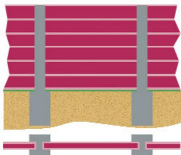
**Grafik 15: Mobile Hochwasser-Schutzwand** aus Betonpfeilern und Dammbalken. Auch bei höheren Überflutungen (im Meter-Bereich) besteht noch wirkungsvoller Schutz.
