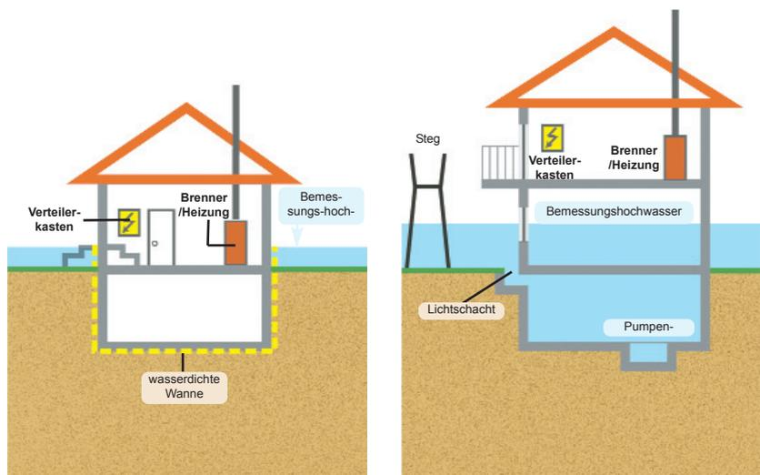
**Grafik 18: Hochwassersichere Installation von Stromverteiler und Heizungsanlage.** In den von Hochwasser potenziell betroffenen Bereichen (Keller, Erdgeschoß) sollten die Installationen möglichst hoch über dem Fußboden angebracht werden. Auf Ölheizungen sollte in hochwassergefährdeten Gebieten grundsätzlich verzichtet werden (Gefahr von Ölaustritten!).
