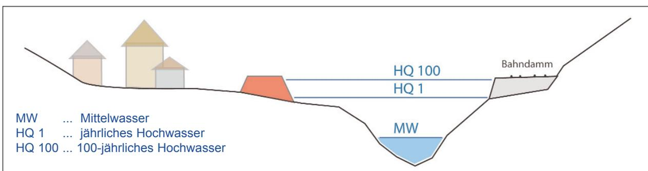
**Bemessungshochwasser.** Nach den einschlägigen Richtlinien wird für Hochwasserschutzmaßnahmen das "HQ100" als Bemessungshochwasser angesetzt, also jenes Ereignis, das durchschnittlich nur einmal in 100 Jahren auftritt.
