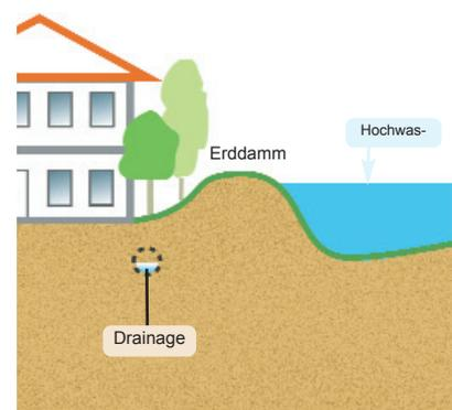
**Grafik 15: Hochwasserschutzbauten sind nur dann wirksam, wenn keine Unterströmung der Schutzbauwerke stattfindet und sich kein Rückstau aus dem Kanal bilden kann.**
