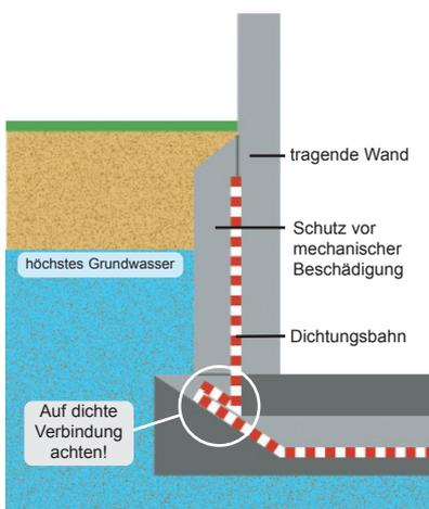
**Grafik 11: "Schwarze Wanne" als Außendichtung.** Die betroffenen Gebäudebereiche werden allseitig von Bitumen- oder Kunststoffbahnen dicht umschlossen.
