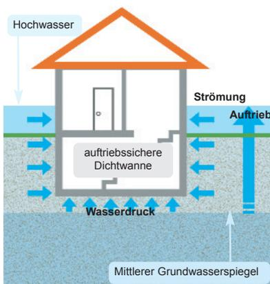
**Grafik 2: Auswirkungen von Grundwasseranstieg und Überschwemmung.** Auftriebskräfte, Wasserdrücke und Strömungskräfte beanspruchen die Fundamente und Mauern. Im Extremfall kann es zum "Aufschwimmen" des Gebäudes oder zum Durchbruch von Mauern kommen.
