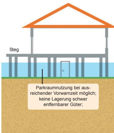
**Grafik 9: Bauen auf Stützen.** Bei ausreichender Vorwarnzeit besteht die Möglichkeit, den überbauten Raum für untergeordnete Zwecke zu nutzen (keine Lagerungen). Auf die Zugänglichkeit ist durch Stege, höher gelegene Notausgänge (große Fenster, Balkone etc.) zu achten.
