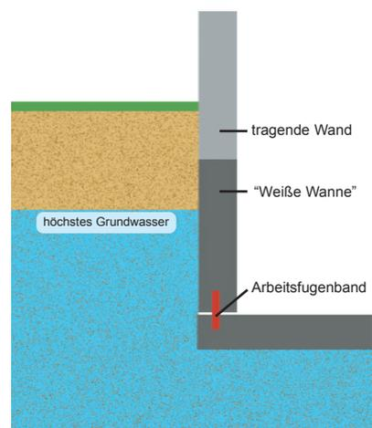
**Grafik 13: "Weiße Wanne".** Außenwände und Bodenplatte bestehen aus wasserundurchlässigem Beton.
