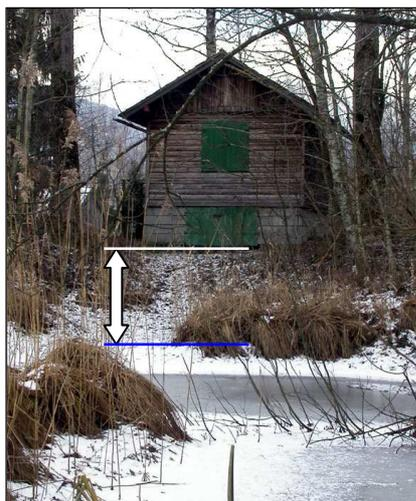
Abb. 19: Bootshütte. Wasserspiegel war nach mündl. Auskunft Hr. Schmied bis Ende der 60er-Jahre (zumindest im Sommer) bis zur unteren Kante der Bootstüre eingespiegelt. Höhendifferenz knapp über 1 m (blaue Linie gibt den Wasserstand im Sommer wieder) (Photo: Büro Stipa)
