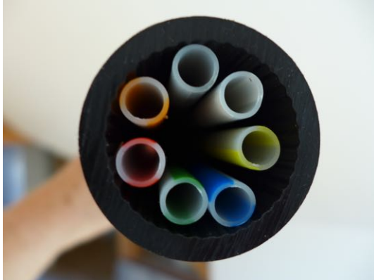
DA 50 mit 7 Subrohren 10/1 mm (7 x 96 = 672 Fasern)
