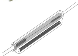
Schrumpf-Spleißschutz (Schrumpföfen in Spleißgerät integriert)
