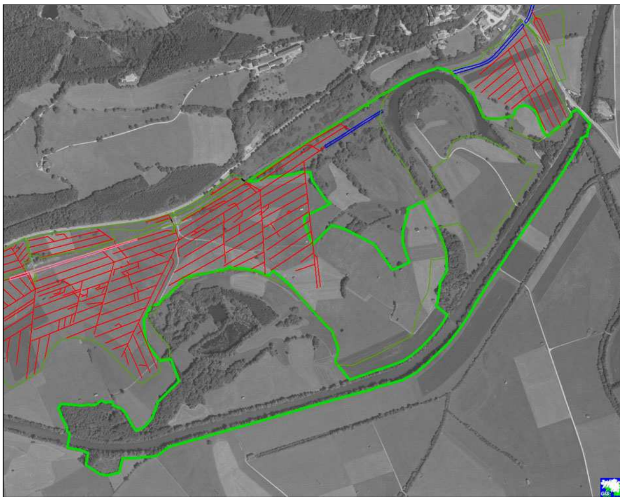
Abb. 10: Lage der Drainage- (rot) sowie der Entwässerungsgräben (blau) in Relation zum NATURA2000-Gebiet (hellgrün). Quelle der Drainagenetzdaten: BBL Liezen, Hr. Ing. Gruber
