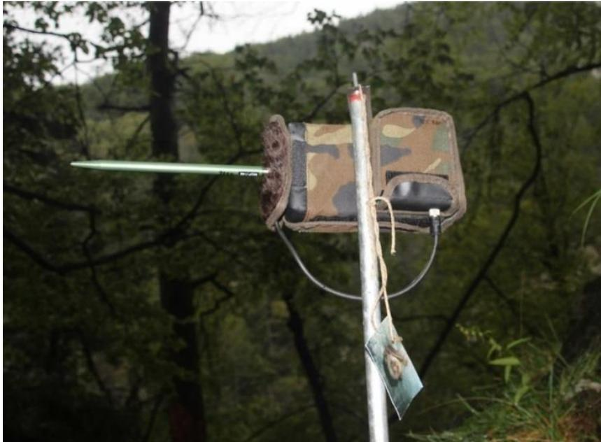
Abbildung 1: Batcorder (Foto: O. Gebhardt)
