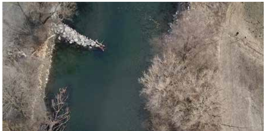
Abb. 3: Die Bühnen zeigen Wirkung. Eine Tiefenlinie hat sich gebildet und das Sediment der Fließgeschwindigkeit entsprechend sortiert © Karl Sackl
