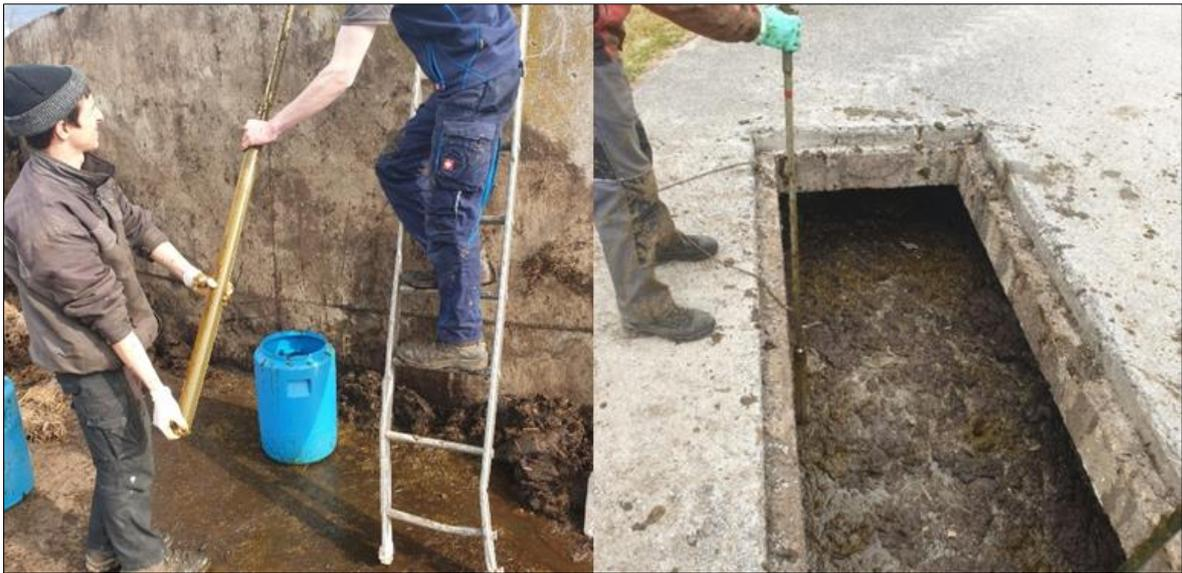
Abbildung 6: Probennahme mittels Multisamplermethode (Quelle: Schiefer und Simoner, 2023)
