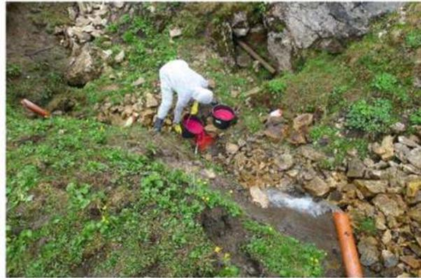
Abb. 3: Einspeisung von Sulforhodamin G in den Schnittlamoos-Ponor. Auflösung des Tracers in 2 x 15 L Schwindenwasser. Einspeiser F. Schmidt in Schutzkleidung (Foto: R. Benischke).
