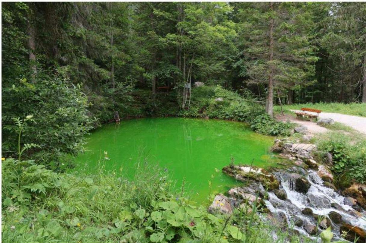
Abb. 5: Intensive Grünfärbung des Sagtümpels (SGT) am 03.07.2023 durch Uranin (Foto: R. Seebacher).
