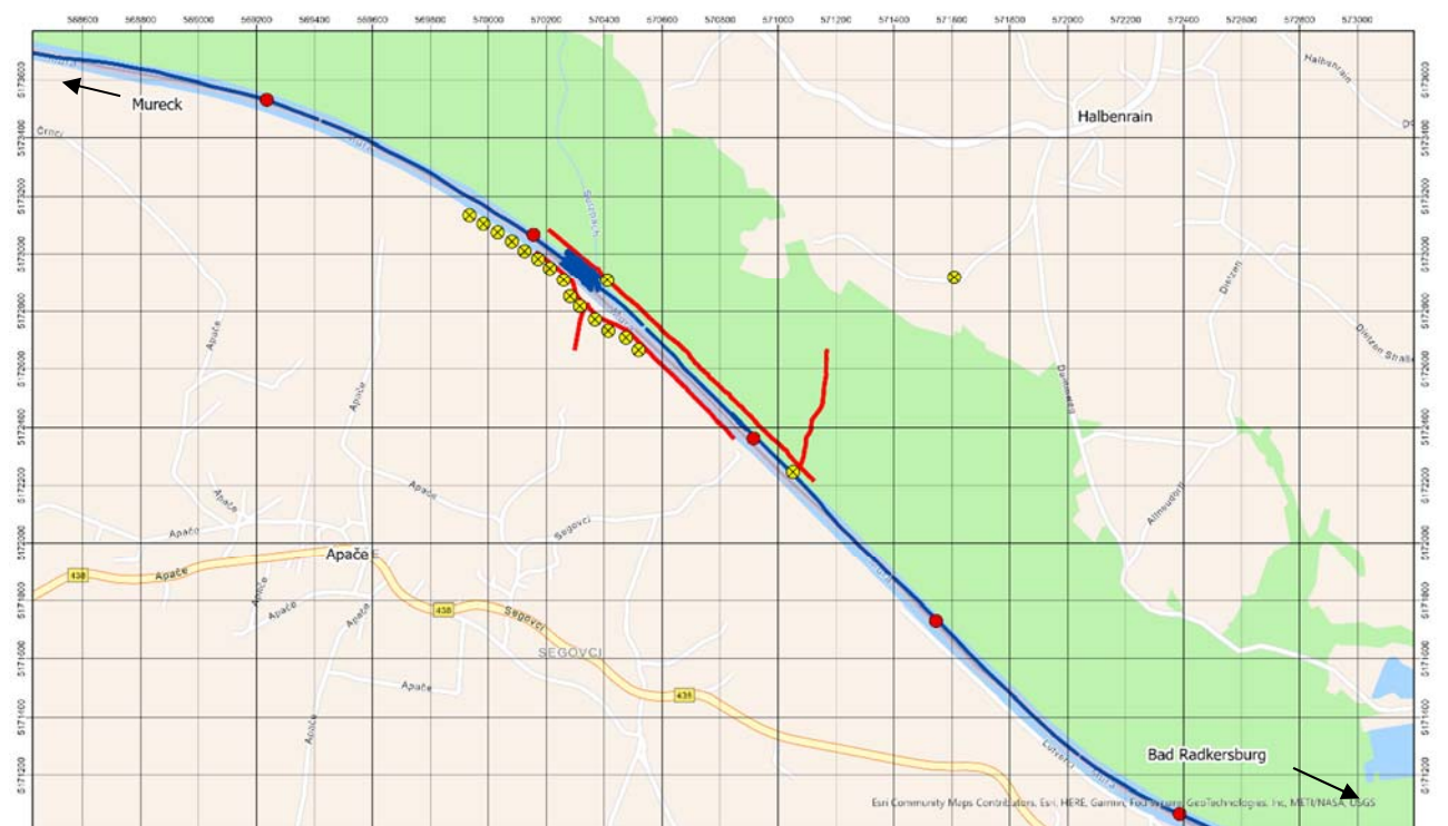
Abbildung 1: Übersichtslageplan der geoelektrischen Profile (rot) und Sub-Bottom Profiling Daten (blau). Die vorhandenen Bohrungen sind mit gelben Kreissymbolen und Kontrollprofile der Multibeam Daten mit roten Kreisen eingetragen.
