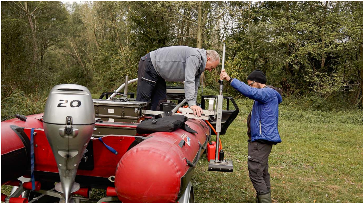
Abbildung 18: Montage des Messsystems Innomar SES2000 auf das BOKU-Messboot.
