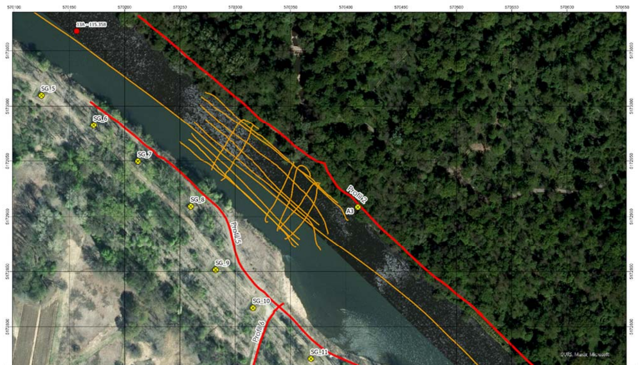
Abbildung 5: Lageskizze des Messgebietes mit der Lage der geoelektrischen Profile (rot), sowie der Sub Bottom Profiling Messlinien (orange).
